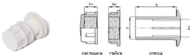
**1-ый ШАГ.** Просверлить отверстие в пластиковой емкости. Отверстие высверливается перовым или пустотелым (кольцевым) сверлом для дерева или гипсокартона. Диаметр отверстия выбирается в соответствии с диаметром резьбы отвода. Необходимый диаметр отверстия вы можете выбрать из таблицы №1. После подготовки отверстия необходимо обработать “заусенцы”, образовавшиеся после высверливания.
